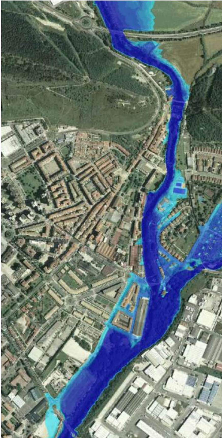
Imagen 2. Peligrosidad por inundación para un periodo de retorno de 100 años. Fuente: SNCZI
